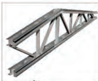
Конструктивная схема здания, возводимого с применением ЛСТК-Элш профиля
