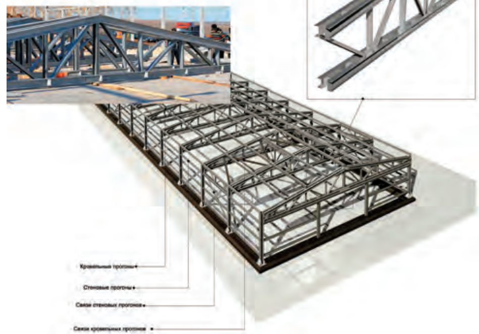
Конструктивная схема здания, возводимого с применением ЛСТК-Элш профиля
