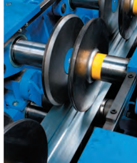
Линия непрерывного действия ZEMAN по производству легких стальных тонкостенных конструкций на Самарском заводе «Электрощит» — Стройиндустрия»
